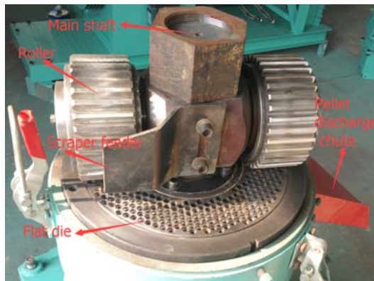
Flat die pellet mill structure
